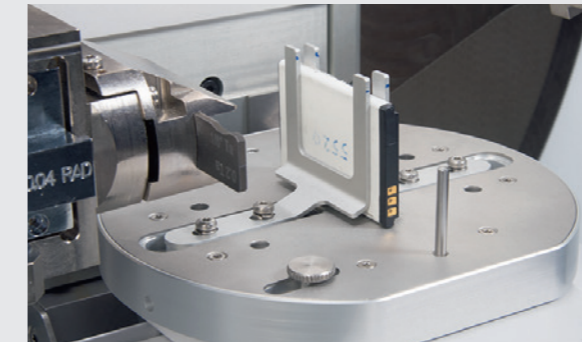
Empyrean XRD에 파우치와 각형형 셀이 장착된 모습. 파우치 셀에 압력을 가하는 메커니즘도 지원됩니다.
