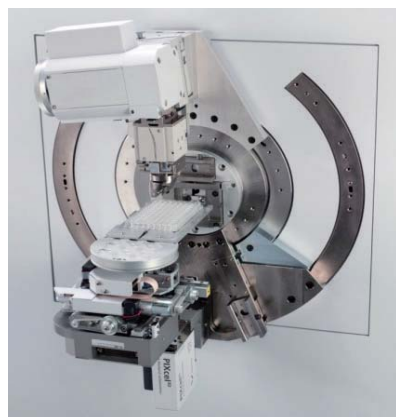
ウェルプレートを用いた透過測定
