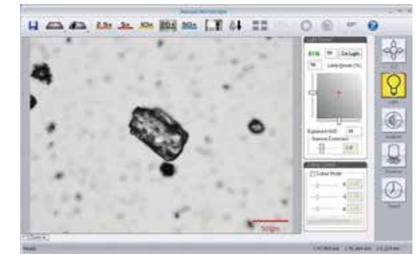
指定した粒子の位置へ自動的に移動し、レーザー光を照射してラマン分光法による化学同定を行います。
